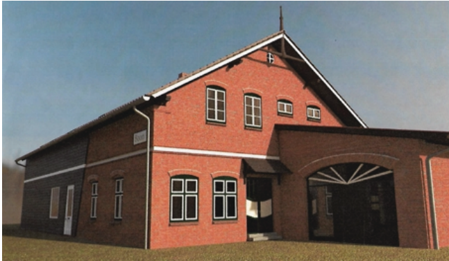
Die Planzeichnung zeigt, wie das Kulturhaus Boon nach Fertigstellung aussehen soll. Der ehemalige Eingangsanbau wird durch eine große Dielentür ersetzt. Bauzeichnung: privat
